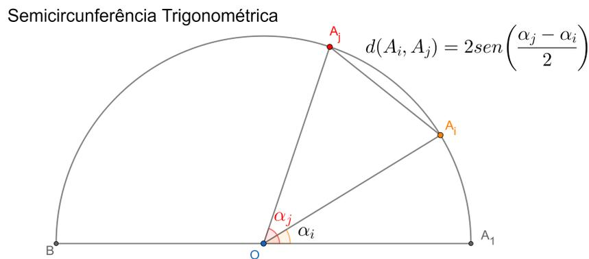
Figura 5.5: Distância entre dois pontos medida por uma corda na semicircunferência trigonométrica (raio 1).
